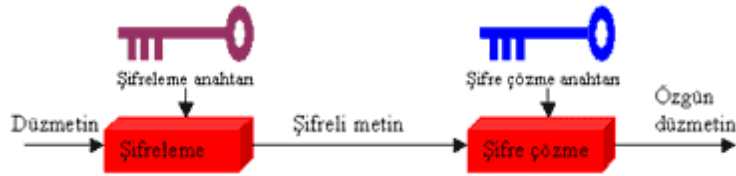
Şekil 1.4. İki farklı anahtar ile şifreleme ve şifre çözme
