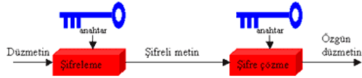
Şekil 1.3. Tek anahtar ile şifreleme ve şifre çözme
